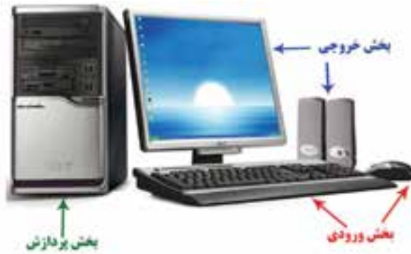
شکل ۱-۲- بخش‌های مختلف سیستم رایانه‌ای
